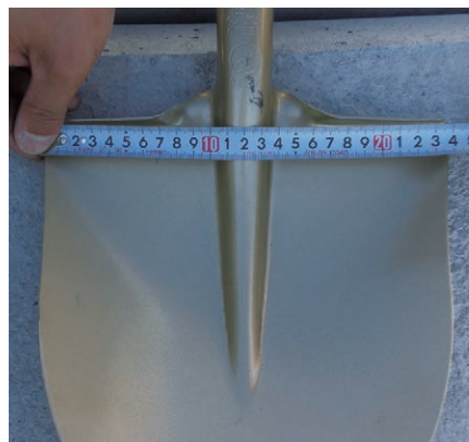
■剣先スコップ(標準型)最大幅：235mm
