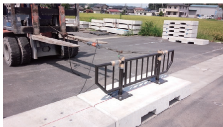
耐荷重試験状況
